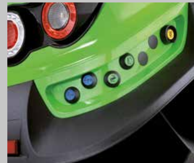
Hydrauliku, EHR i vývodovou hřídel je možné ovládat pomocí externích tlačítek na obou blatnících.
