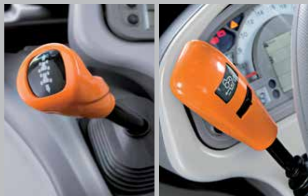
Mechanická reverzace nebo Powershuttle s pěti nastavitelnými stupni agresivity – rozhodnutí je jen na Vás.
