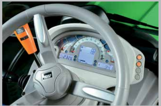
InfoCentre. Analogové a digitální zobrazení provozního stavu stroje.
