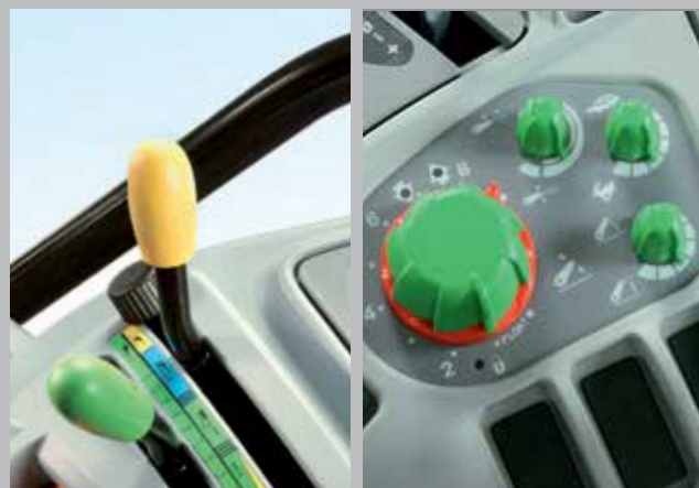
Mechanické nebo elektronické ovládání zadních tříbodových závěsů. Rozhodnutí je jen na Vás.
