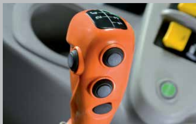
Pohodlná řadicí páka a Powershift. Jednoduché řazení stiskem tlačítka bez nutnosti aktivace spojky.
