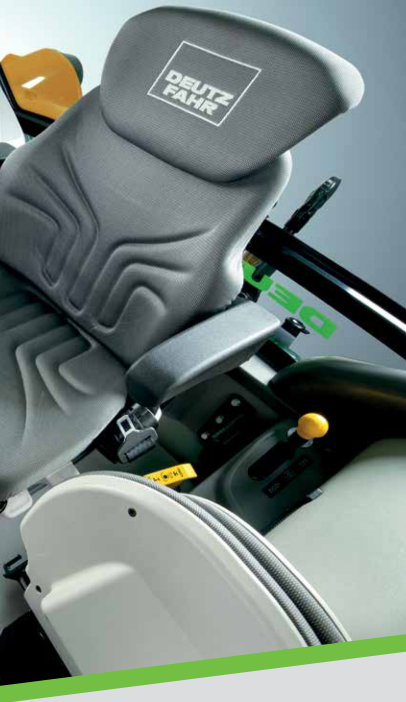
Snížení vibrací v kabině až o 40 %. Odpružení díky „hydro-silentblokům“.
