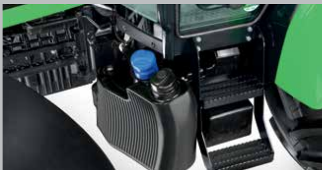
Nádrž, která pojme až 145 litrů paliva a 10 litrů přísady AdBlue umožňuje dlouhou pracovní dobu (v závislosti na modelu).
