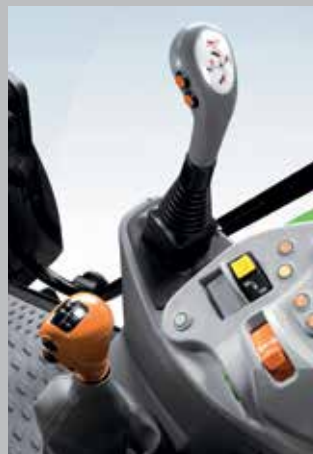
Joystick čelního nakladače s tlačítka Powershift, Stop&Go, systému rychlého řízení SSD...
