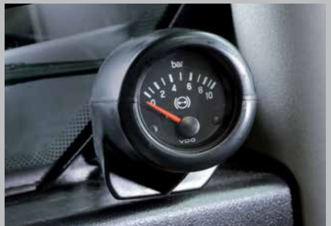
Systém vzduchové brzdy (volitelně) pro spolehlivé brzdění těžkého zadního vlečného zařízení.
