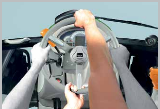
Systém rychlého řízení SSD. Poloviční otočení volantem, dvojnásobná síla řízení.
