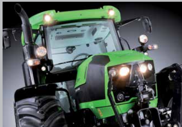
Pro optimální viditelnost nejen při špatném počasí. 8 pracovních světlometů zabudovaných ve střeše a v bočních sloupcích. Dva pracovní světlometry na kapotě.
