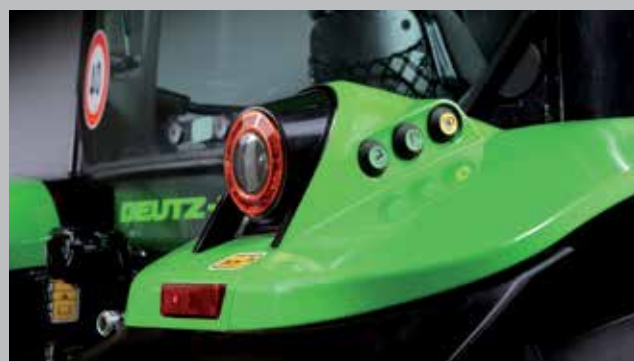
Externí ovládání vývodových hřídel a tříbodových závěsů pro snadné upevnění a provoz přídatného zařízení.
