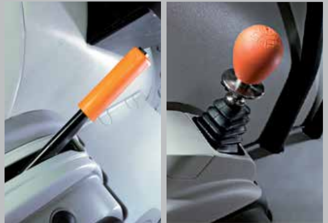
Mechanická nebo hydraulická parkovací brzda. Rozhodnutí je jen na Vás.
