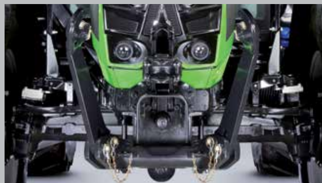
řední tříbodový závěs a vývodová hřídel. Zvedací kapacita 2 100 kg a 1 000 u vývodové hřídele.
