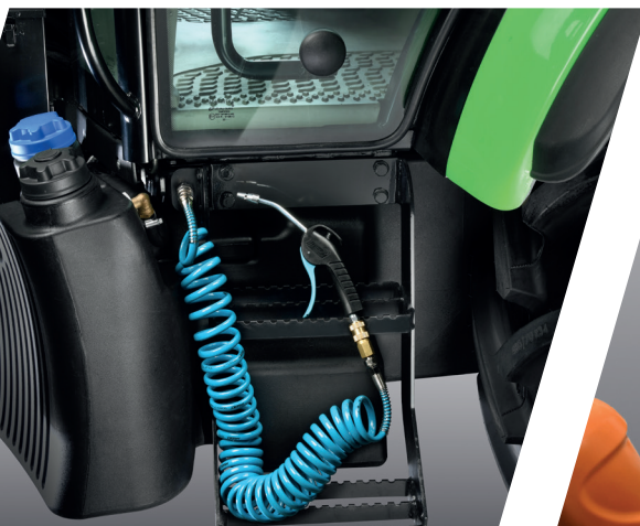
> Vnější a vnitřní vzduchové přípojky pro příslušenství vzduchového kompresoru.
