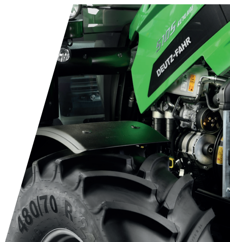
> Motor FARMotion 45 s výkonem od 75 do 106 k s SCR nebo bez něj. (Pouze model 5075 Keyline)
