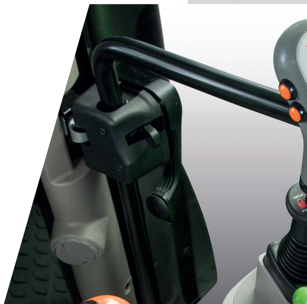
> Joystick s řazením Powershift pro snadnou obsluhu čelního nakladače.
