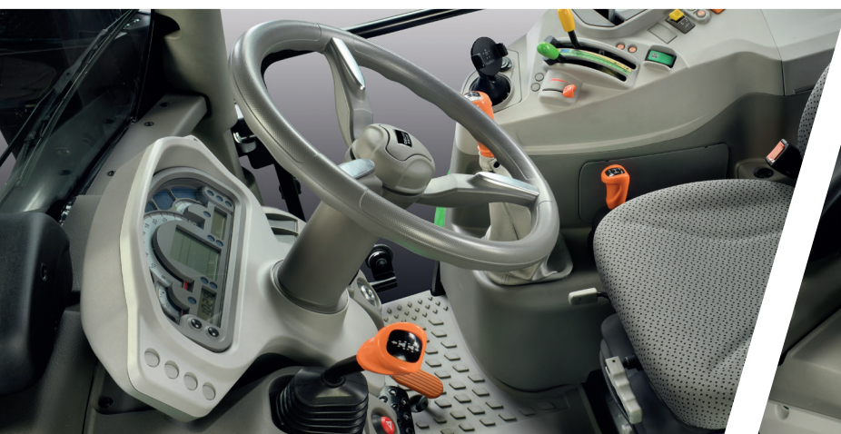
> Mechanická reverzační jednotka s ergonomickou pákou reverzoru na sloupku řízení.
