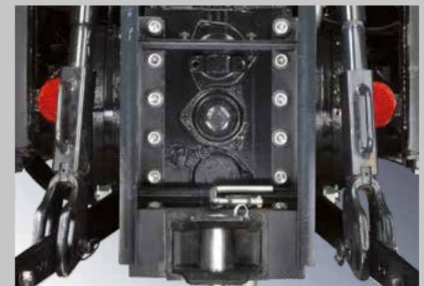
Zapfwelle: 540 oder 540/540ECO oder 540/540ECO/1000 oder 540/540ECO plus Wegzapfwelle sind wählbar.
