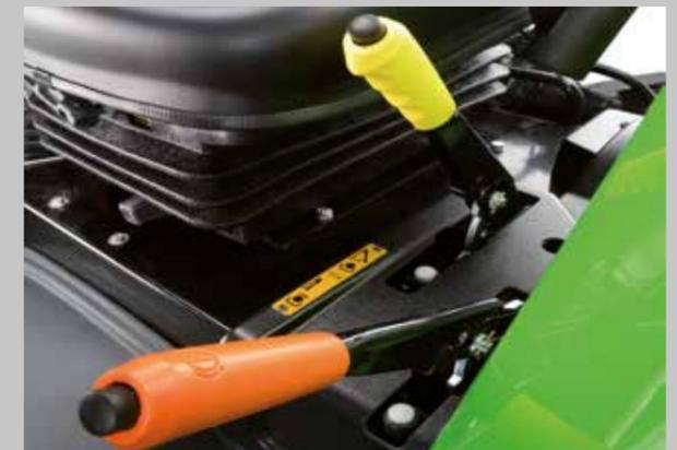
Parkbremse und Zapfwellen- bedienung griffgünstig links.
