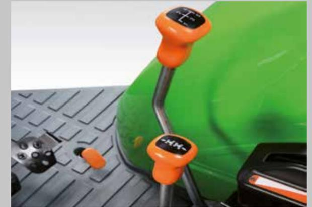
Getriebe- schaltung, Handgas, Motordrehzahl- speicher, Heckkraftheber und Hydraulik- steuerung griffgünstig rechts vom Fahrer.
