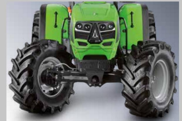
Die taillierte Ölwanne des tragenden Motors ermöglicht einen Lenkeinschlagwinkel von bis zu 55°.
