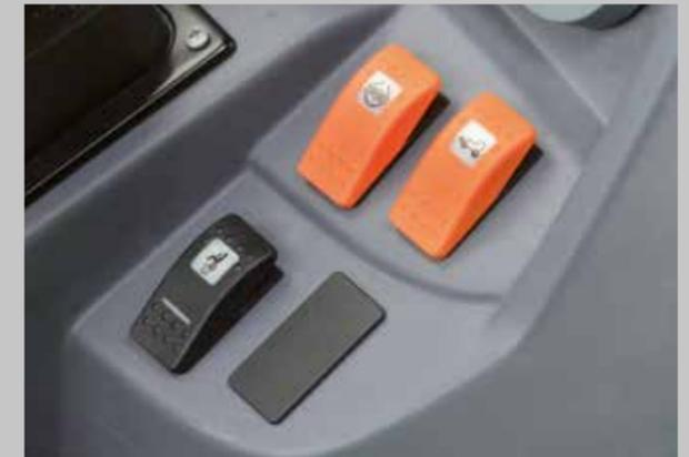
Wahlweise mechanische oder elektrohydraulische Zuschaltung von Allradantrieb und Differenzialsperre.
