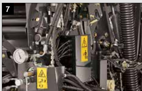
Proporcionální ventil pro ovládání utužení balíků z kabiny traktoru
