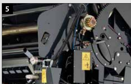
5 Proporcionální ventil pro ovládání lisovacího tlaku z kabiny traktoru
