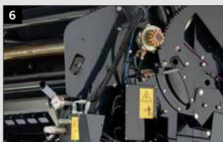
Proporcionální ventil pro ovládání utužení balíku z kabiny traktoru
