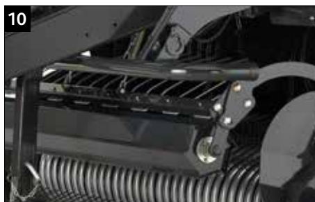
Velký přitlačný válec na plodiny (Ø 217 mm)
