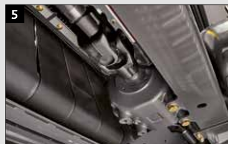
5 Křížové klouby v hnacích hřídelích určené pro velká zatížení
