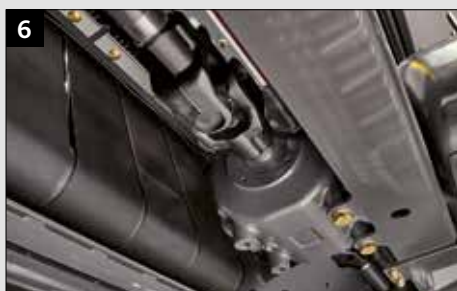
Křížové klouby v hnacích hřídelích určené pro velká zatížení
