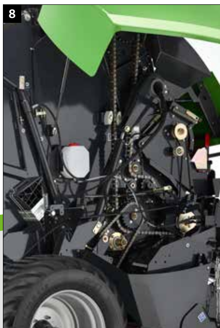
Robustní pohon s velmi kvalitními řetězy IWIS + 1¼" 20BH hlavní pohon s chromovanými kalenými čepy
