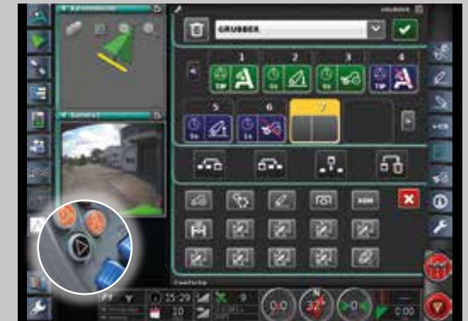
Comfortip: plná integrace ovládání naváděcích systémů do traktorového ovládání (včetně souvratového managementu).
