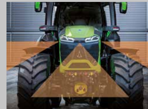
Aktivní rozeznání osoby před traktorem a varování řidiče.
