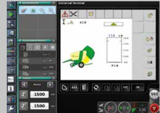
Stroje pro sklizeň píce, zpracování půdy a další zařízení nepředstavují pro ISOBUS žádný problém. Všechny se ovládají pomocí iMonitoru 2.
