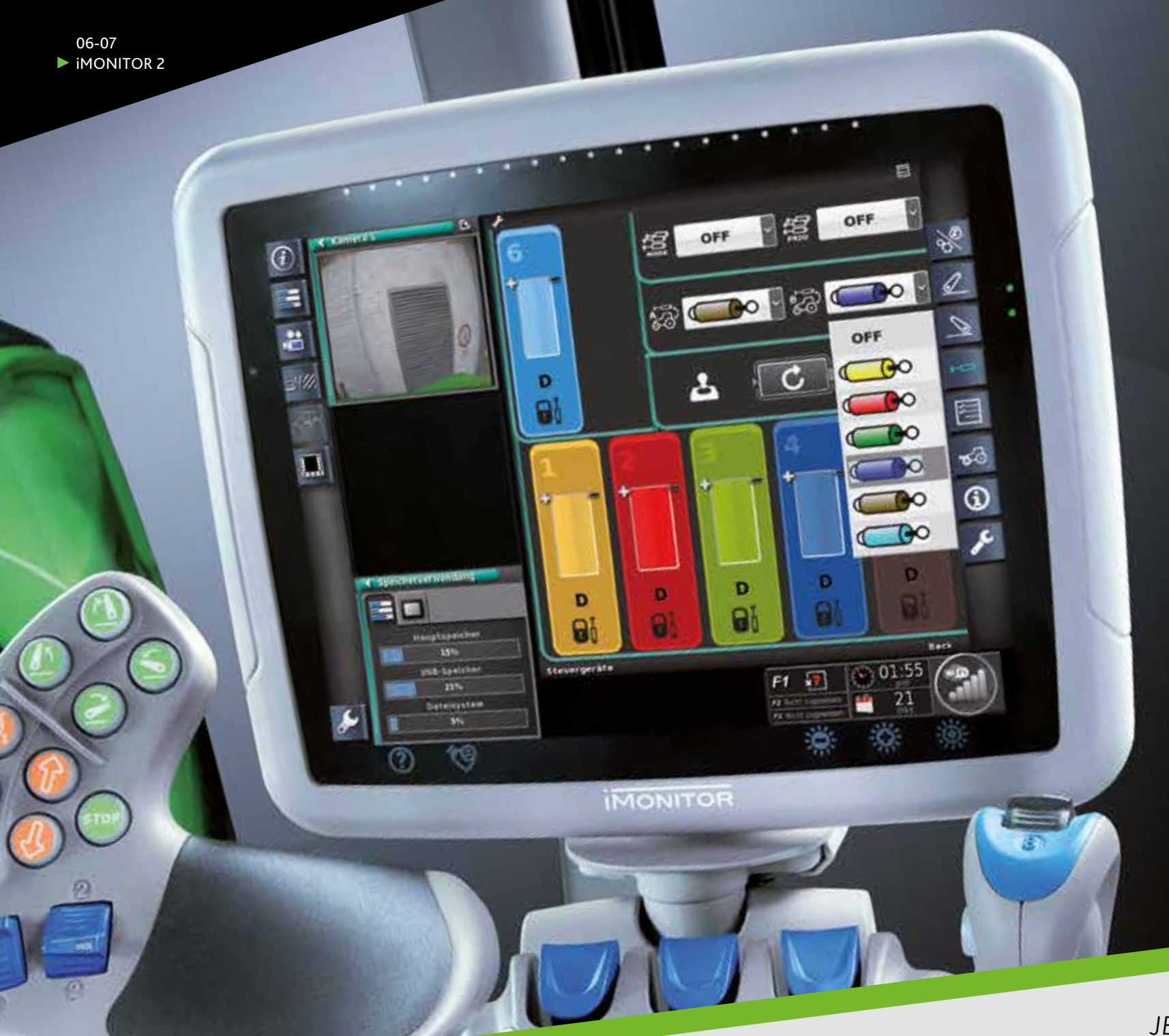
ISOBUS aplikace v iMonitoru 2: variabilní uspořádání ovládacích polí zvyšuje komfort používání.
