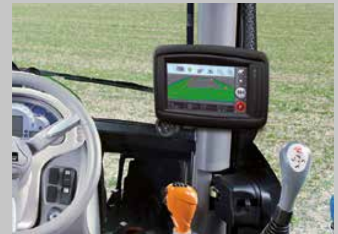
Visual Guidance 25: variabilní, ale kompletní systém pro manuální navádění a dokumentaci. Ideální varianta pro vstup do precizního zemědělství.
