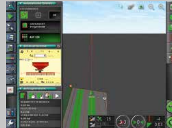
Propojení rozhraní DEUTZ-FAHR ISOBUS a systému AGROSKY umožňuje automatické ovládání sekci při seti, hnojení a dalších činnostech.
