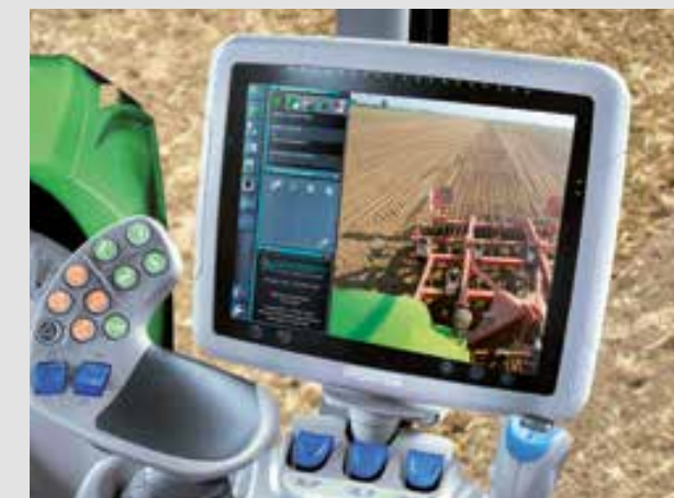
Integrovaná kamera s automatickým přepnutím do plného zobrazení (např. při couvání) zvyšuje přehled a bezpečnost.
