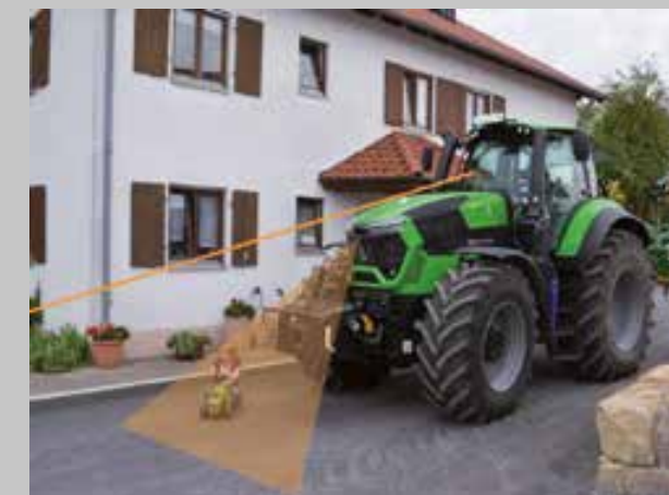
Čím větší je traktor, tím větší je také prostor před traktorem, který není viditelný z kabiny traktoru.
