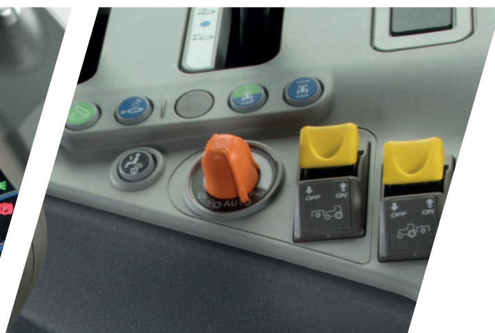
> Snadné a intuitivní - pomocí potenciometru nastavení ECO/Power může obsluha změnit způsob řazení APS (Automatic Powershift).
