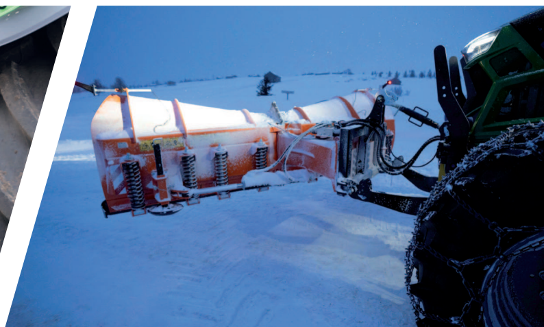
> Přední TBZ s regulací odlehčení umožňuje nastavit přítlak na nářadí a přenášet hmotnost na přední nápravu.
