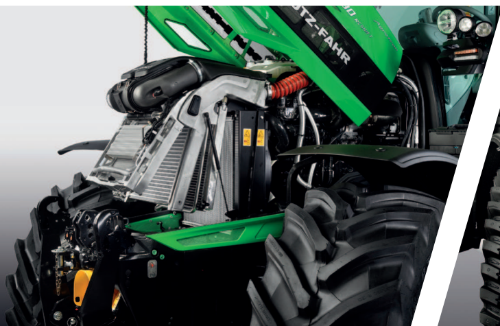
> Hliníkový chladicí systém Performance + s jednoruční uvolňovací pákou u modelů 6160-6190.
