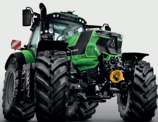
> Přední odpružená náprava se 100% uzávěrkou předního diferenciálu.
