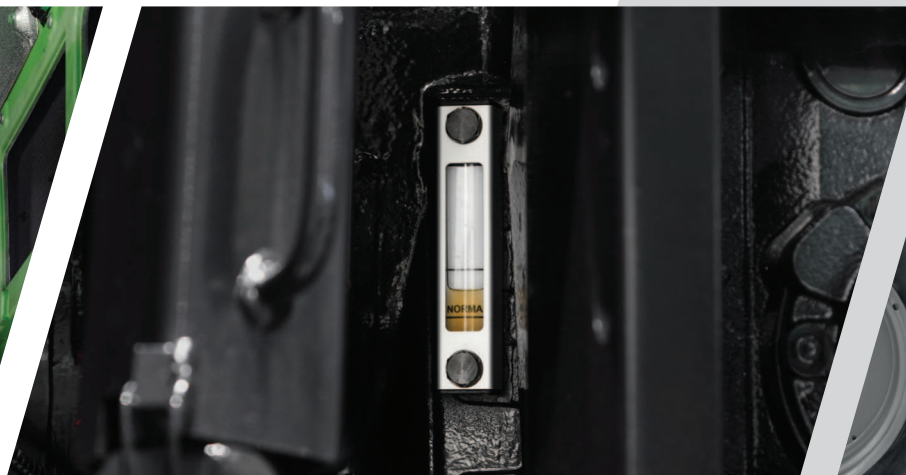
> Praktický průzor pro kontrolu hladiny oleje v zadní části traktoru.
