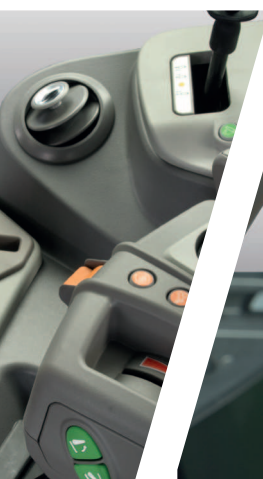
> Páka PowerShuttle s nastavením SenseClutch.
