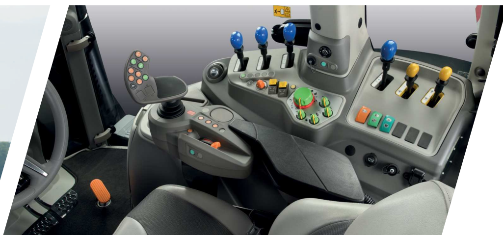
> Vybavení kabiny MaxiVision s plně mechanickými zadními hydraulickými okruhy v kombinaci s převodovkou Powershift (velký obrázek) a RCshift (obrázek vpravo dole).
