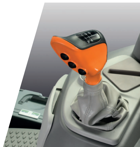
> Ergonomická řadicí páka s tlačítky ComfortClutch, APS a Powershift.
