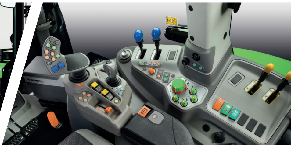
> Smíšená konfigurace se 2 mechanickými a 2 elektrickými hydraulickými okruhy
