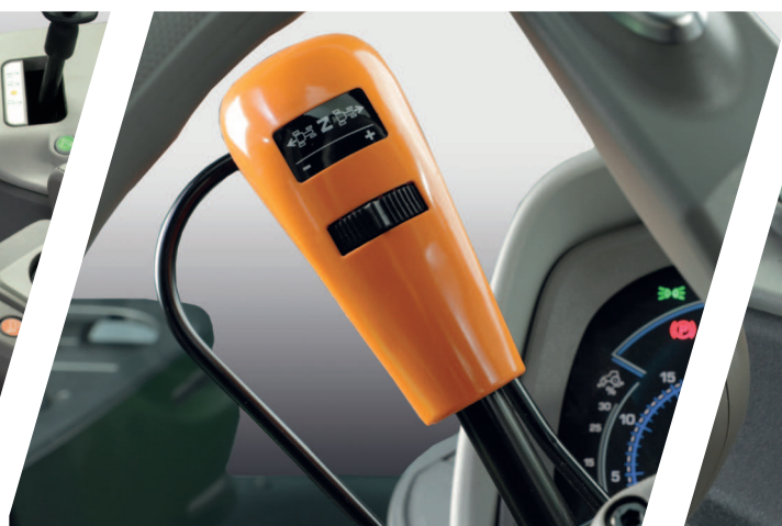
> Páka PowerShuttle s nastavením SenseClutch.
