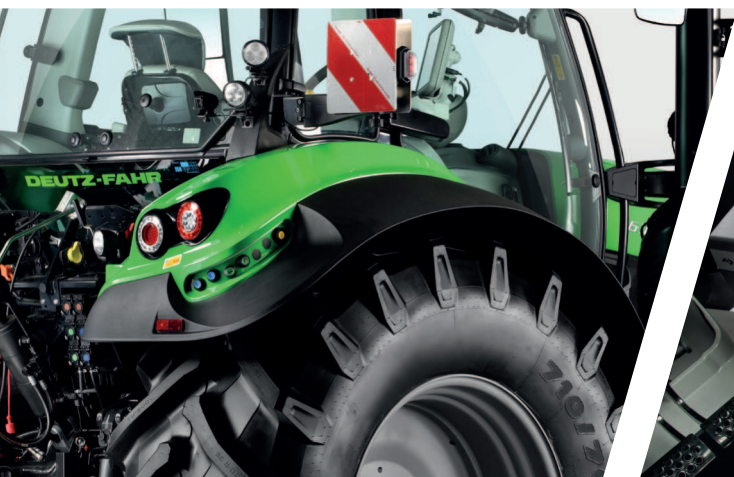
> Externí ovládání na obou stranách pro zadní TBZ, vývodový hřídel (PTO) a až jeden hydraulický okruh.
