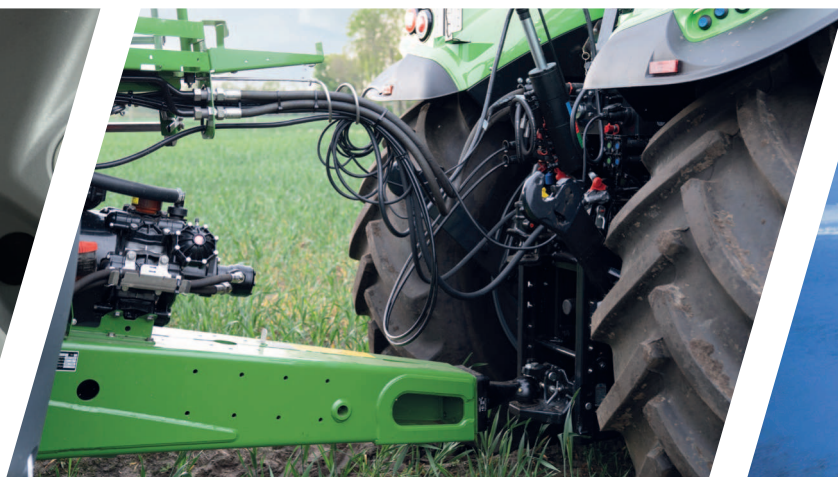
> Zadní TBZ v přepravní poloze, kdy spodní ramena při zatáčení nenarazí na oj návěsu (pro 6190 TTV - 6230 HD TTV).
