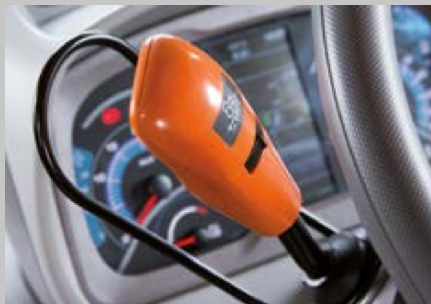
Elektrohydraulická reverzace Powershuttle SenseClutch pro precizní a bezpečnou změnu směru jízdy i s nákladem bez přerušování točivého momentu.
