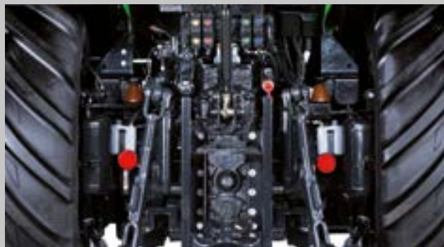
Ohromující vlastnosti: kapacita zdvihu až 7000 kg, kategorie III N a kompletní elektrohydraulické ovládání standardem.
