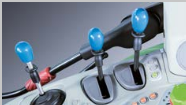
Mechanicky nebo elektrohydraulicky ovládané okruhy - výběr je na vás.
