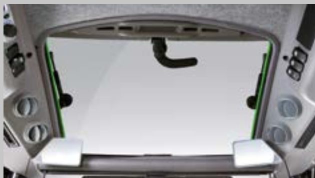
Čtyři varianty provedení střešky: se střešním oknem s FOPS / bez FOPS a neprůhledná střeška s FOPS / bez FOPS.
