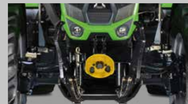
Robustní přední třibodový závěs zdvihne až 2880 kg. K dispozici je též ComfortPack s dalším hydraulickým okruhem vpředu a externím ovládaním pro třibodový závěs.
