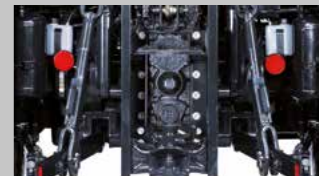
Až čtyři rychlosti PTO vzadu, automatická funkce PTO, přední PTO je dodávané na přání.
