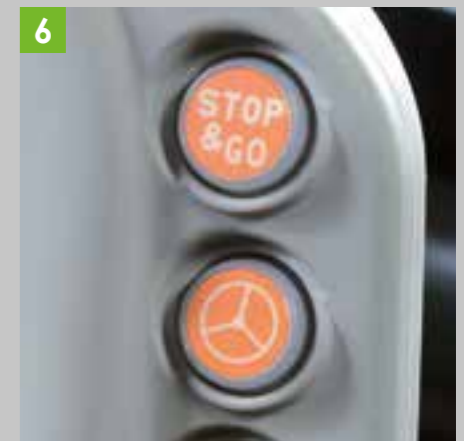
6 Systém rychlého natáčení předních kol SDD a funkce Stop&Go.
