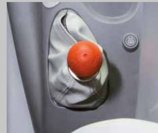
Patentovaná hydraulická parkovací brzda vám umožní zaparkovat svůj nový traktor řady 6 se 100% jistotou.
