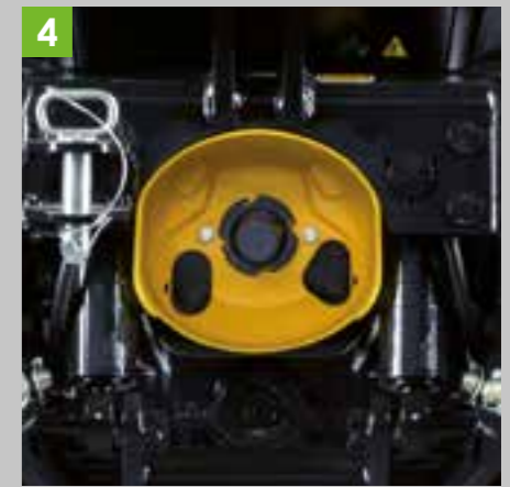
4 Pro ještě větší všestrannost volitelná přední vývodová hřídele.
