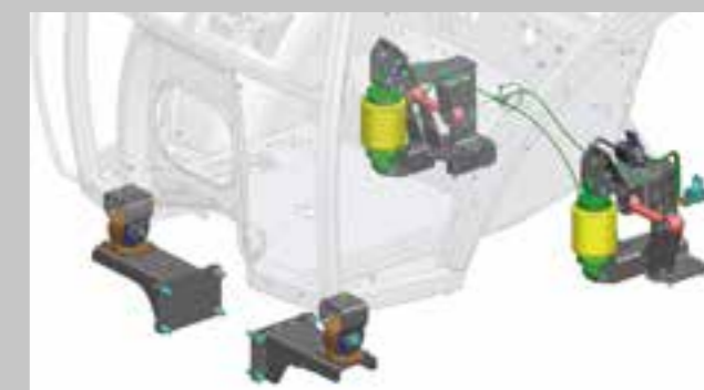
Pneumatické odpružení kabiny poskytuje nejvyšší možný komfort (na přání).
