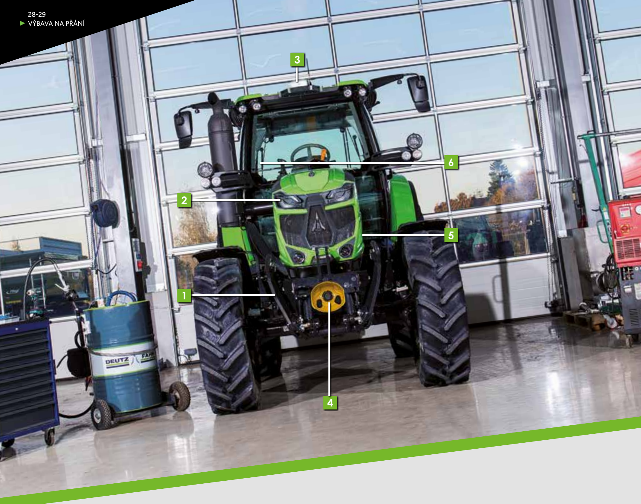
1 Až 22 různých konfigurací hydraulického systému. Například plně integrovaný přední tříbodový závěs.
