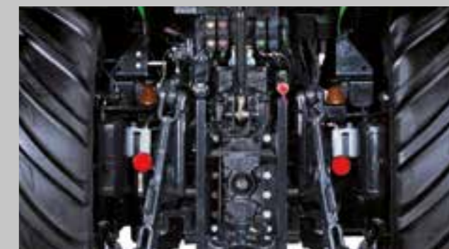
Ohromující vlastnosti: kapacita zdvihu až 7000 kg, kategorie III N a kompletní elektrohydraulické ovládaní standardem.
