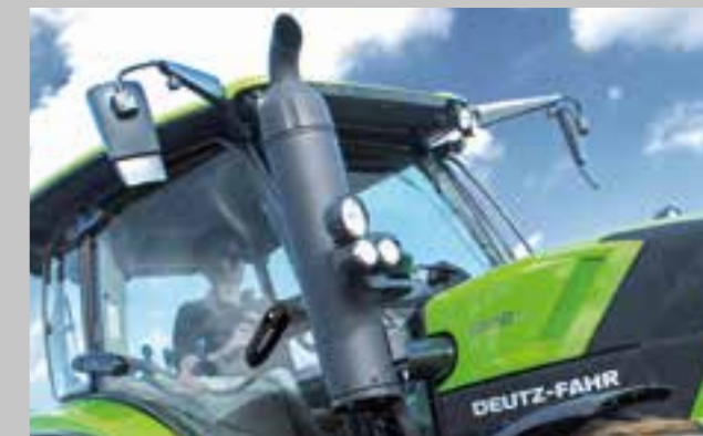
DOC, SCR a DPF (6130-6140) – nový čtyřválcový motor Deutz TCD 3.6 disponuje nejmodernější technologií redukce emisí.
